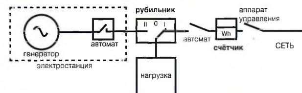
*Схема подключения автономного источника питания с использованием автоматики включения резерва электроснабжения:*
